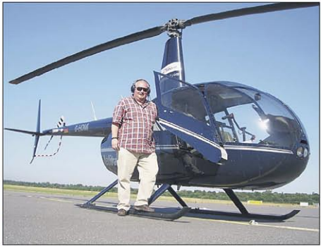
Das obligatorische „Heldenfoto“ vor dem Abflug mit der R 44 Raven des amerikanischen Herstellers Robinson. Der Helicopter verbraucht rund 60 Liter Spezialbenzin pro Stunde.
