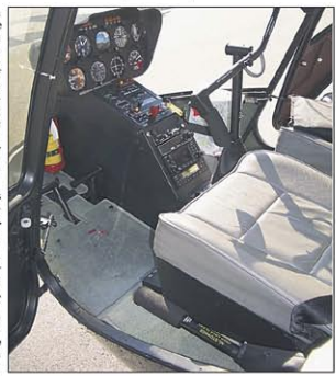
Der Arbeitsplatz: Unten ist der „Pitch“ zu sehen, vorne die Pedale zum Drehen. Das wichtigste ist der Stick in der Mitte für Geschwindigkeit und Richtung.
