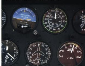
Alles im Griff: künstlicher Horizont, Tachometer, Höhenmesser, Kompass und Öldruck-Anzeige (unten)
